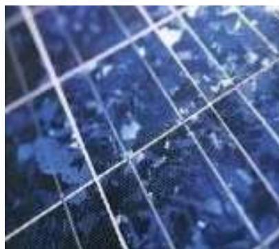
**Figure I.6 :** Cellule en silicium poly-cristallin
