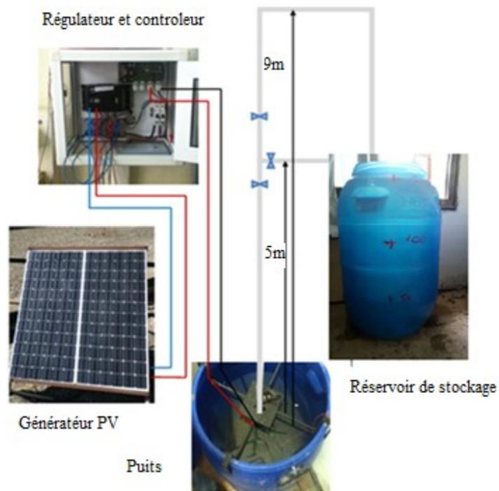
Figure III.7 : Schéma du système de pompage au fil du soleil.
