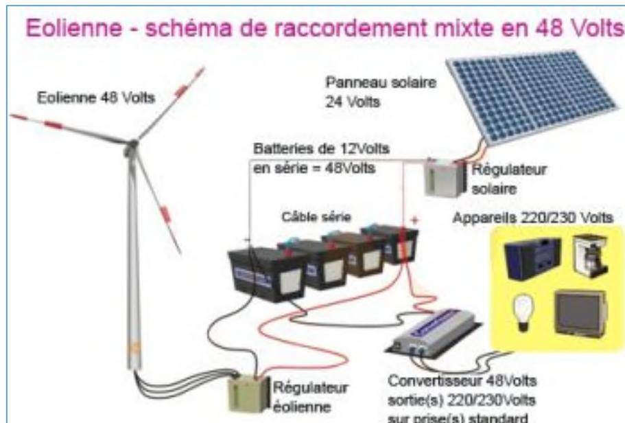
Figure 9 : Système hybride éolienne/solaire [22].
