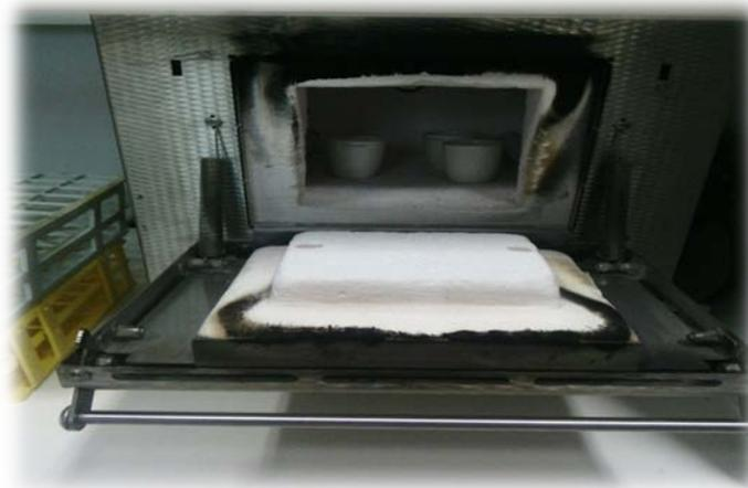
**Figure 08** : Détermination de la teneur en cendre du carbon dans un four à moufle
