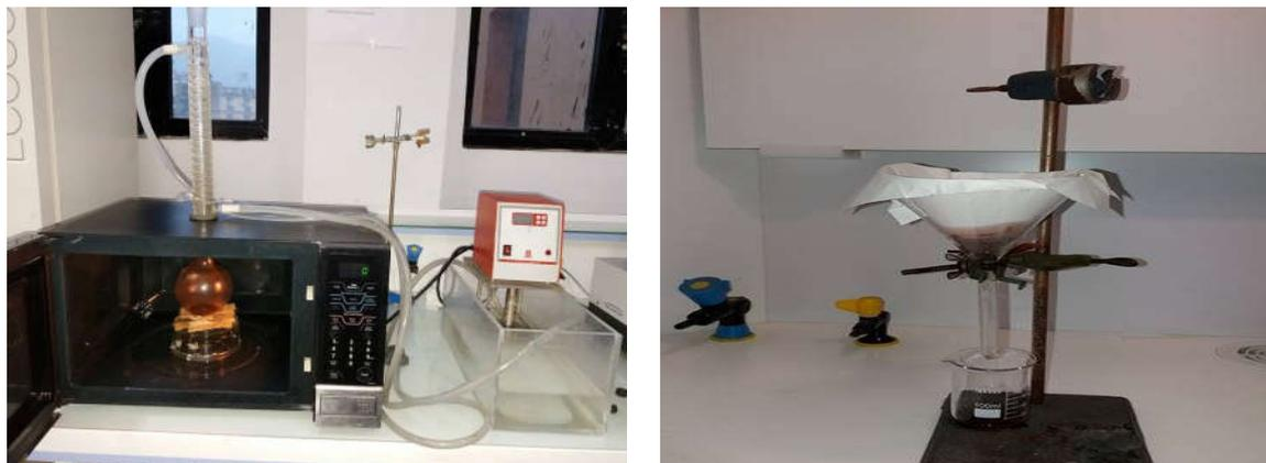
Figure 9. L'extraction assistée par microonde des PT
