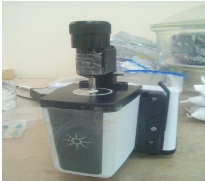
**Figure 5 :** Spectrophotomètre IR (ATR).
