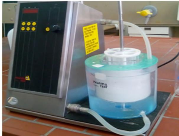
**Figure 7 :** Appareil de délitement.
