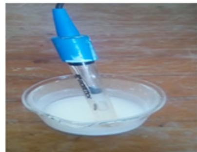
**Figure 8 :** Mesure de pH.
