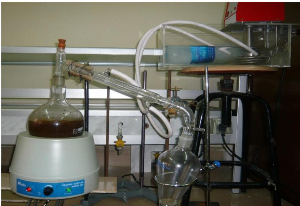
**Figure 5 : Montage d'hydrodistillation de Clevenger modifié**
