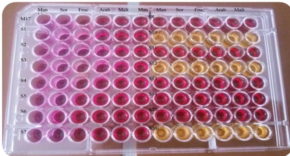
**Figure 5 :** Résultats de teste des sucres sur microplaque
