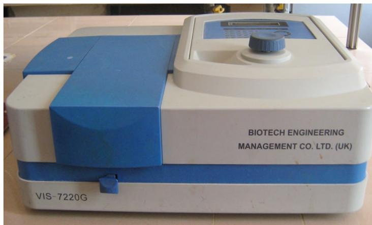
**Figure n°7** : Spectrophotomètre VIS-7220G
