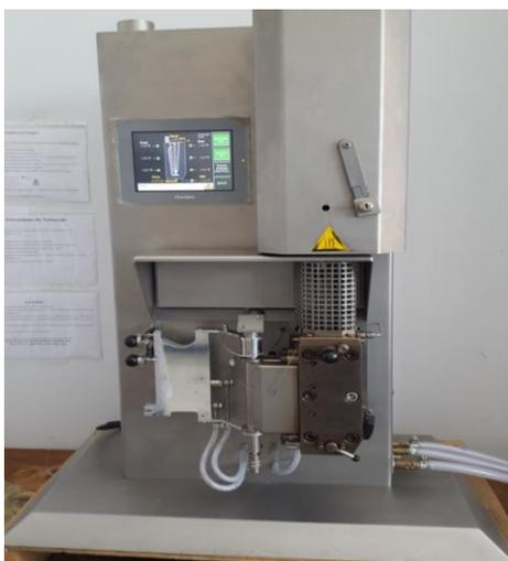
**Figure III. 1.** Photographie de l'extrudeuse
