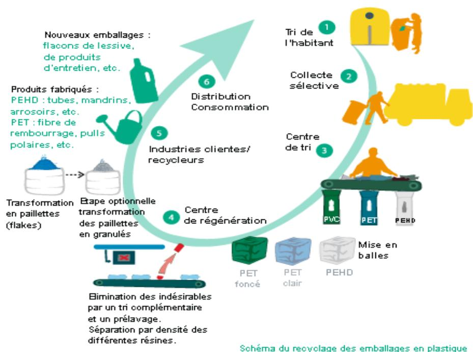
Figure II.2 : Schéma du recyclage des emballages en plastique [66].
