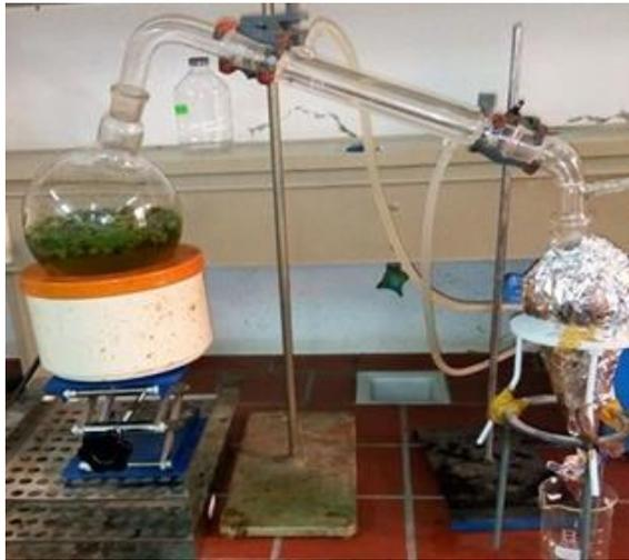
**Figure 5** : Montage utilisé pour l'hydrodistillation.
