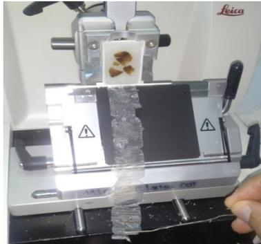
**Figure 12 :** Microtome utilisé pour la réalisation des coupes.
