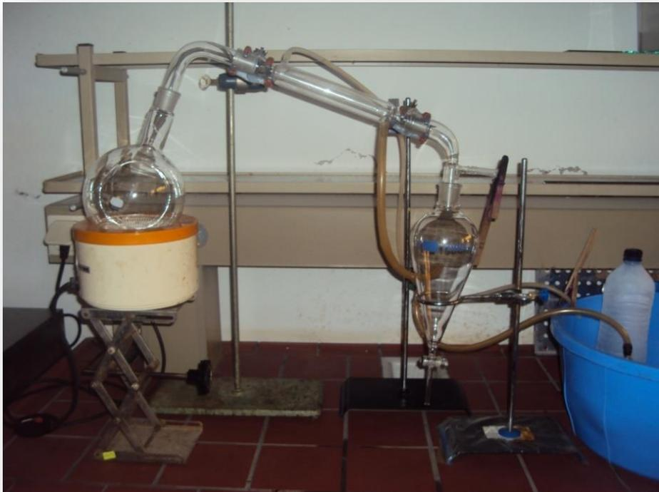
Figure 4: Montage utilisé pour l'hydrodistillation.
