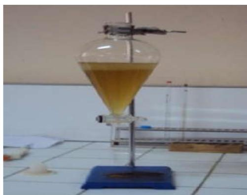
**Figure 14:** Extraction liquide-liquide dans une ampoule à décanter (**origine**).
