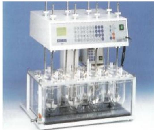
**Figure 09:** appareil a panier
