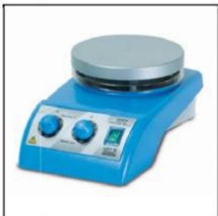
**Figure 12** : Agitateur magnétique
