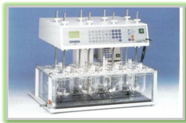
**Figure 08 :** appareil de dissolution in vitro (**Rosetto , 1998**).
