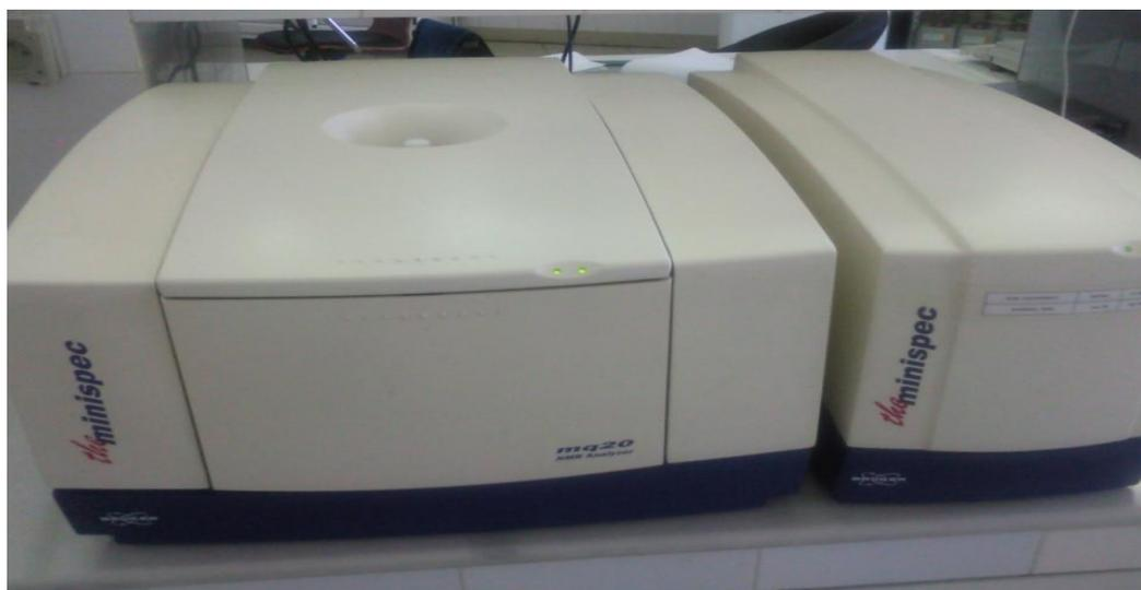
**Figure 8** : Spectromètre à résonance magnétique nucléaire (RMN) basse résolution type (minispecmq 20, Germany).
