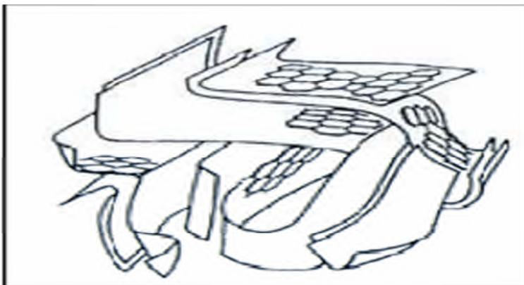
**Figure I.3.** Représentation schématique des microstructures du charbon actif [14].
