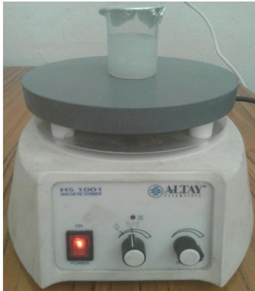
*Figure III.1 : Agitateur magnétique chauffant*
