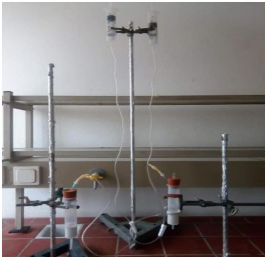
**Figure 2 :** Installation de la colonne de chromatographie effectuée sur gel de silice C18 de type Discovery DSC-18
