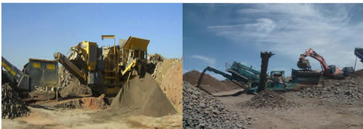
**Figure 20** : Installations de recyclage mobile.
