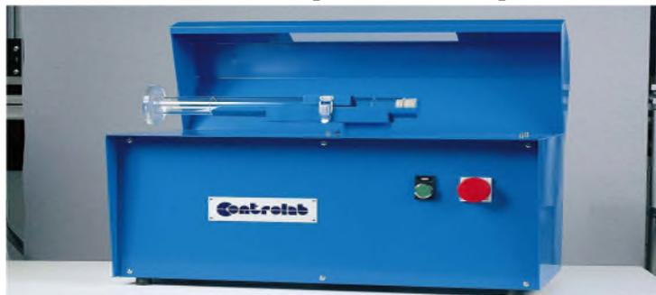
**Figure 49 :** Agitateur d'éprouvettes.
