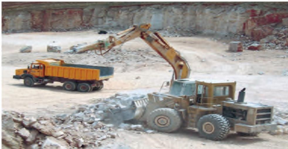
**Figure 5 :** Exploitation d'une carrière à ciel ouvert. [9]
