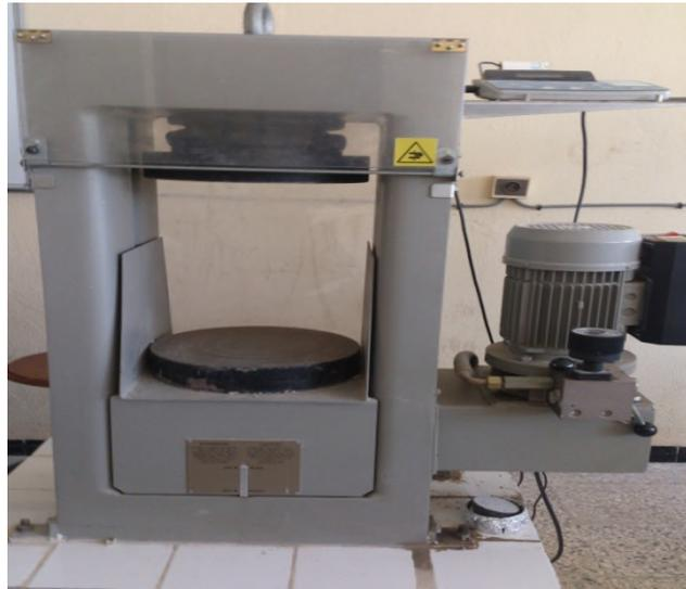
Figure 58 : Appareil d'écrasement des éprouvettes.
