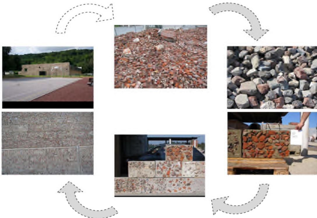
Figure 34 : Schéma représentatif d'une réutilisation directe de déchets de démolition. [2]
