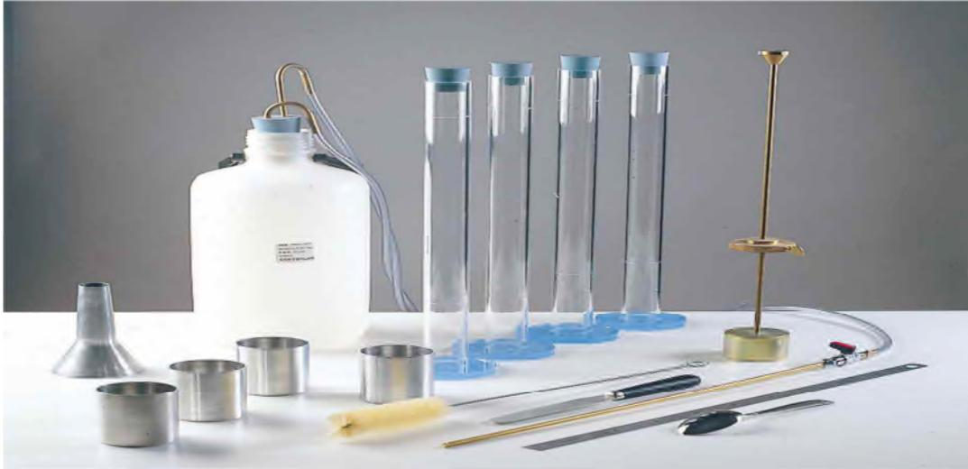
**Figure 48 :** Matériels utilisés pour l'essai d'équivalent de sable.
