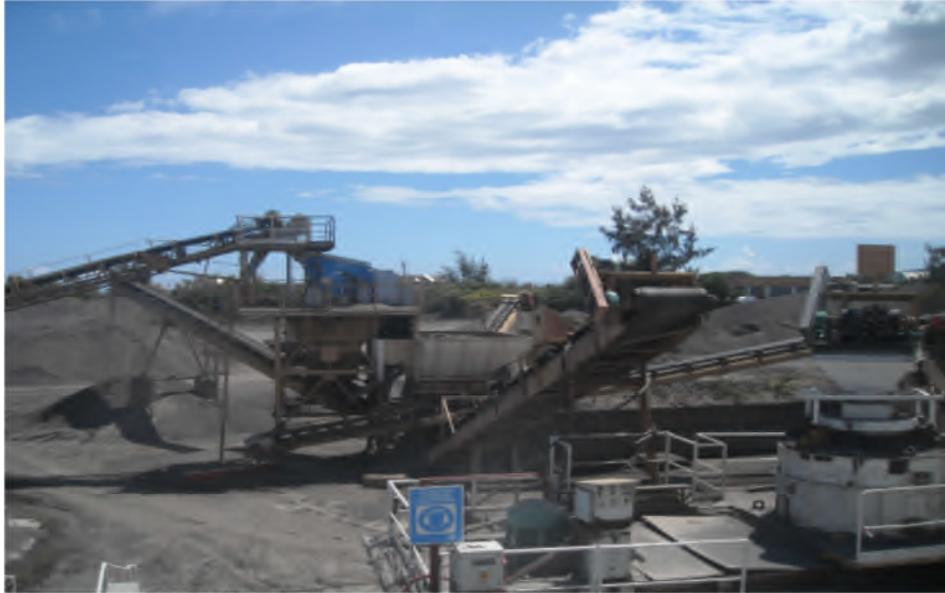
**Figure 8 :** Station de traitement des granulats.
