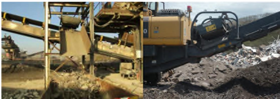
**Figure 25** : Déferrailage par Over-band.
