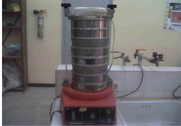
**Figure III.7:** tamiseuse électrique.
