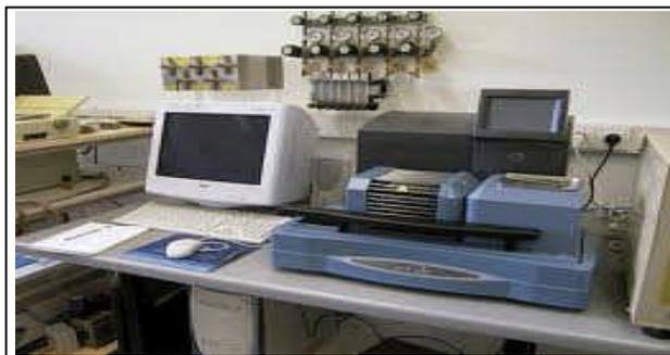
Figure III.6 : Appareil ATD /ATG.
