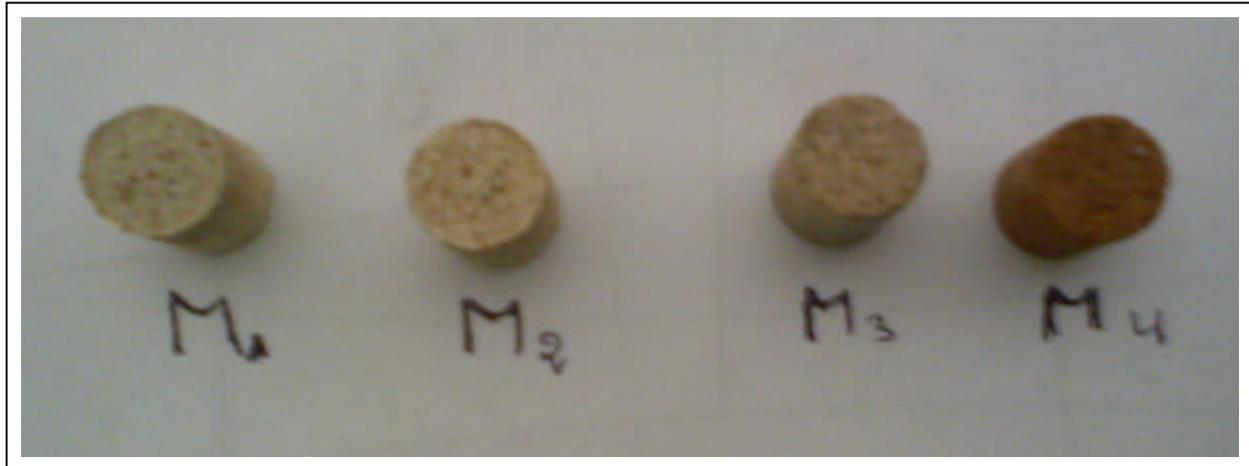
**Figure V.1** : céramiques élaborées pour les différents mélanges à 1100°C
