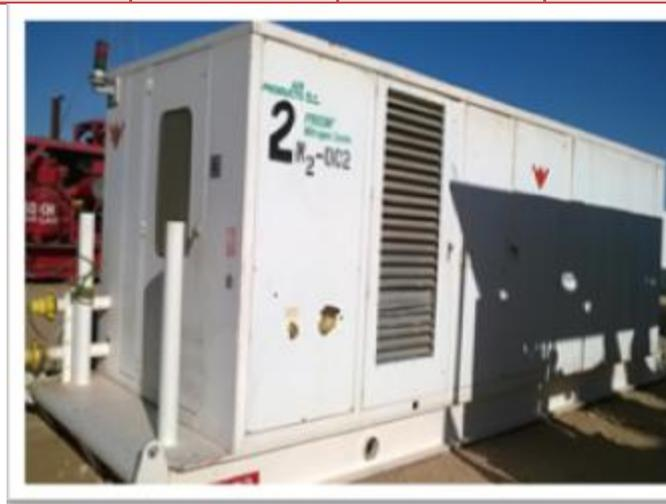
**Figure III.4 :** Unité de production nitrogène.
