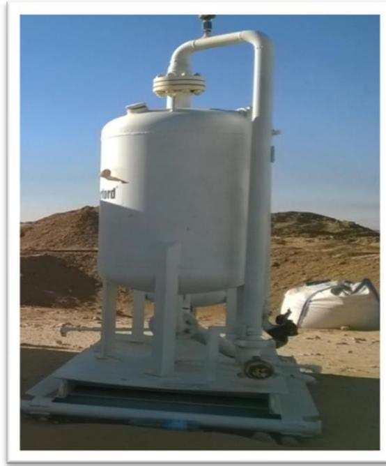
**Figure III.3 :** Refroidisseur d'air (cooler).
