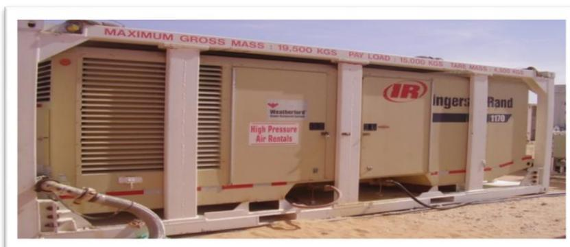
**Figure III.5 :** Amplificateur de pression.
