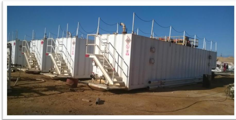
**Figure III.10** : Bacs de décantation d'UBD.
