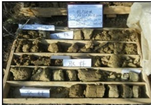
**Figure III.4 :** Marne totalement altérée
