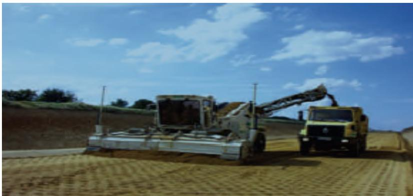
**Figure II. 17:**Rotograde effectuant le réglage d'une couche de forme [23]
