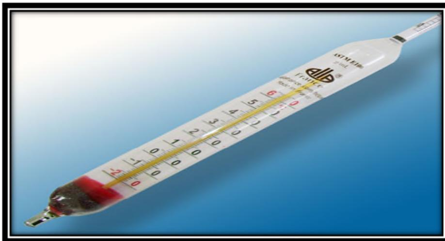
Figure II.1 : Un Aréomètre. [54]
