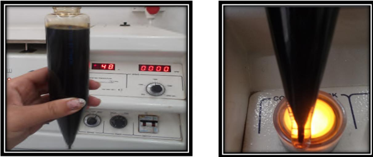
Figure II.4 : Dépôts des sédiments au fond de tube. [118]
