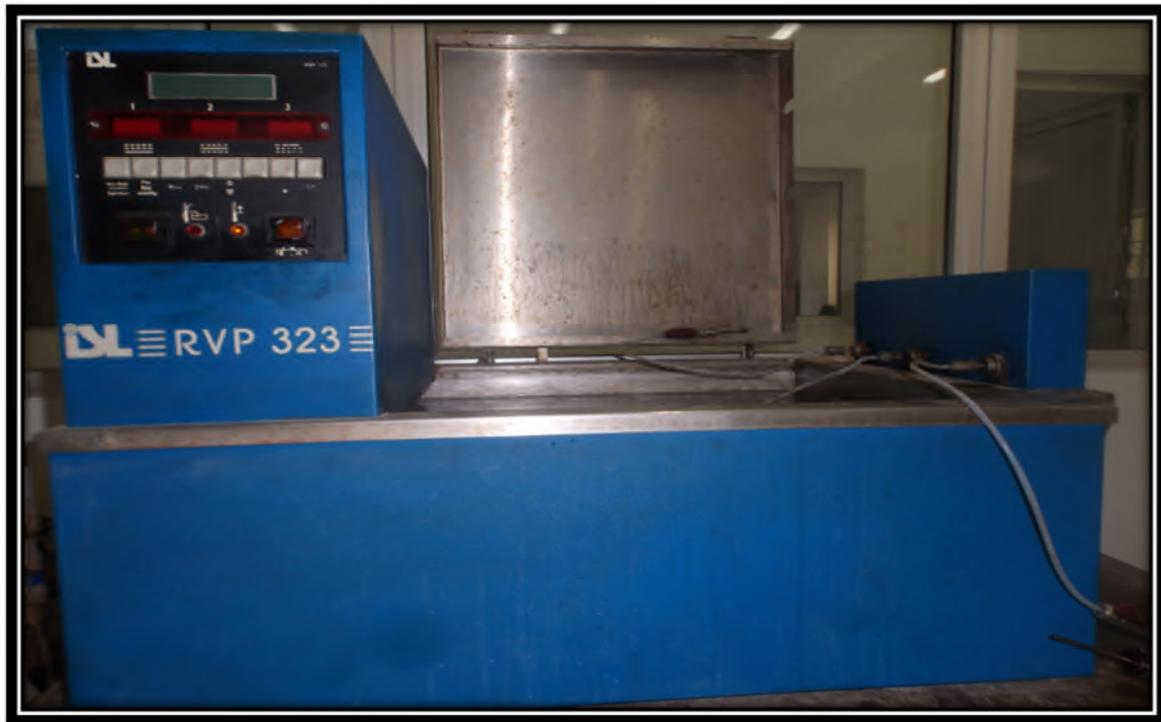
**Figure II.6 : Appareil de mesure de la tension de vapeur. [119]**
