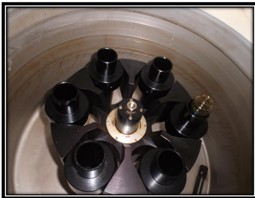
Figure II.5 : L'emplacement des tubes à l'intérieur de la centrifugeuse. [117]
