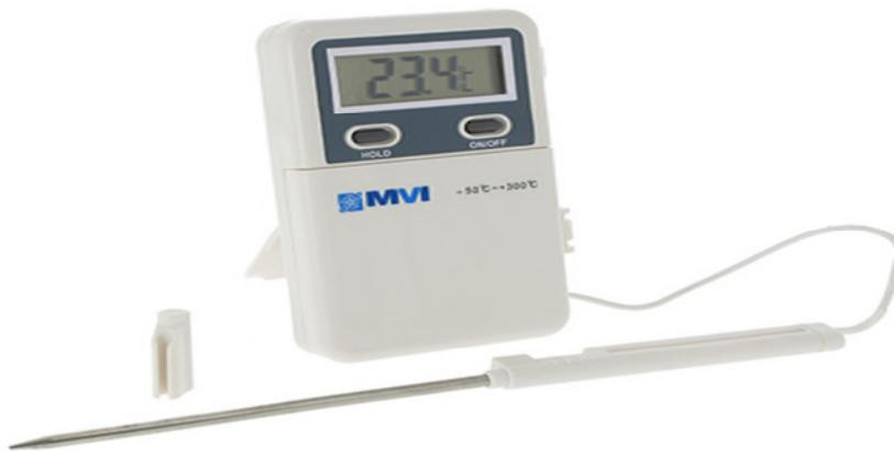
**Thermomètre digital avec sonde.**
