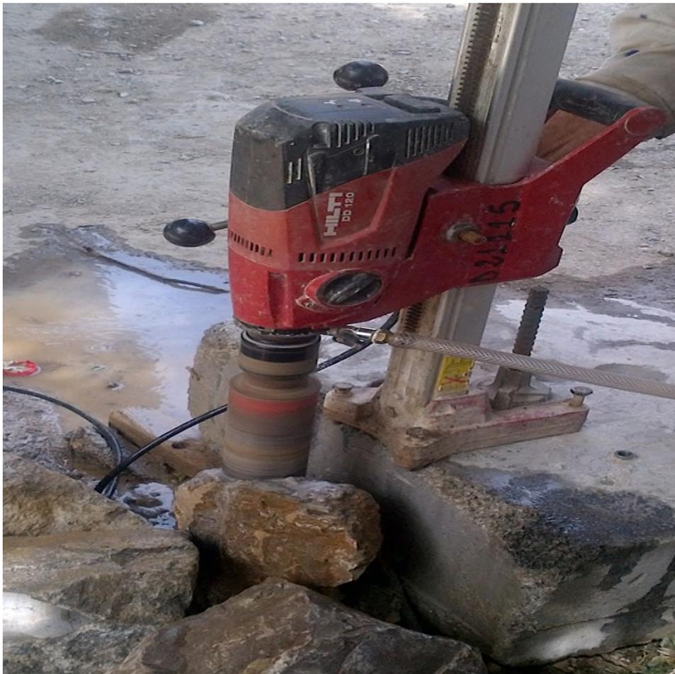
Annexe 2.1 : l'appareil de carottage (la caroteuse) à LTPE-Béjaia.
