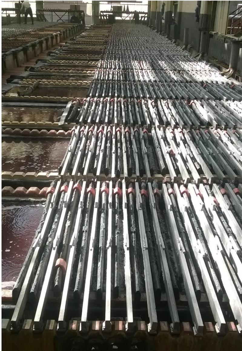
**Figure I-9** : Atelier d'électrolyse de zinc d'ALZINC.
