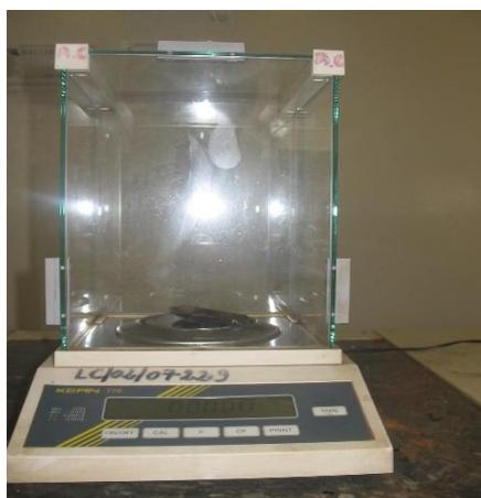
Figure IV-1 : Balance analytique
