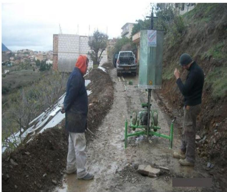
**Figure 37:** Implantation d'un point de sondage pénétrométrique au côté amont du glissement.
