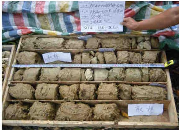
Figure II-4.a Marne totalement altérée. [16]
