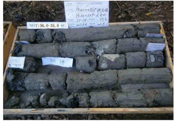
Figure II-4.b Marne intensément altérée. [16]
