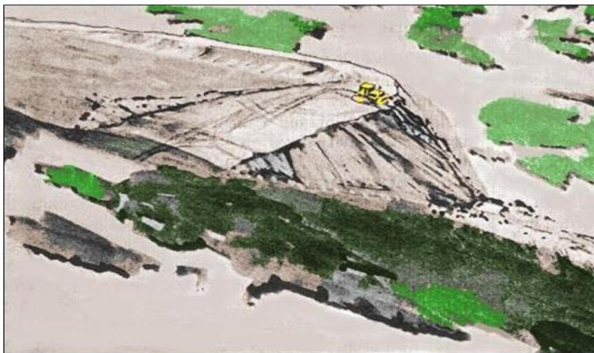
**Figure II.17.** Déversement avec épandage au butoir (push-dumping).
