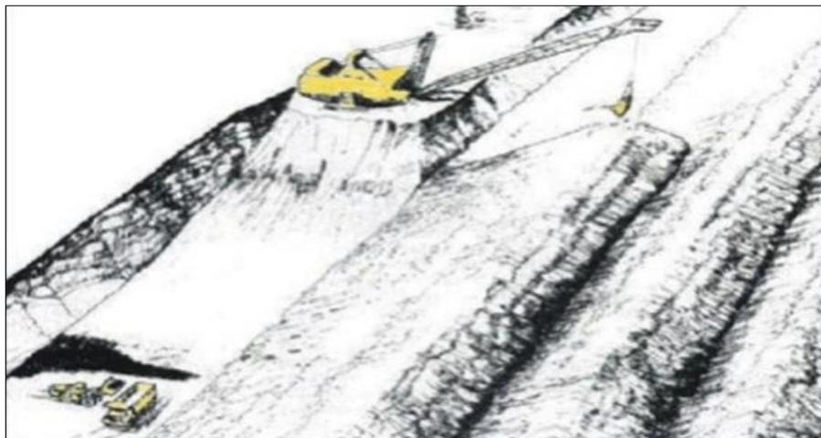
**Figure II.19.** Méthode avec pelle a benne trainante (dragline) .
