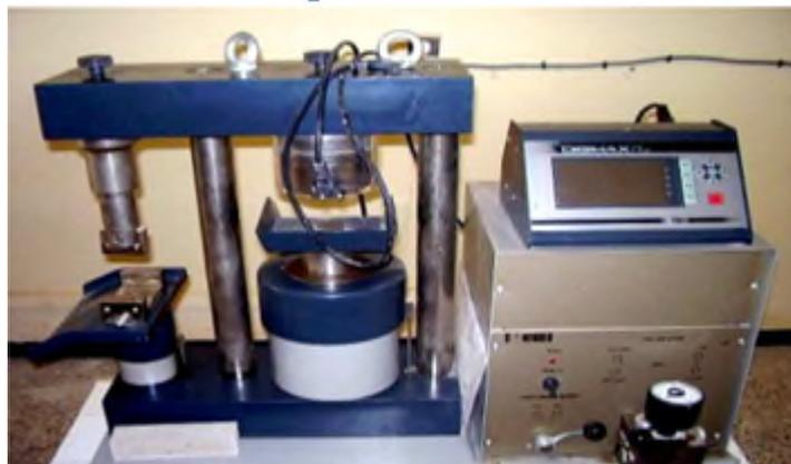
**Figure II.7.**Presse hydraulique de type Controls pour l'écrasement des éprouvettes.
