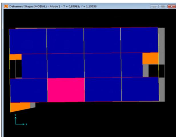
**Figure. IV.3.1** 1<sup>ère</sup> mode (translation suivant X)
