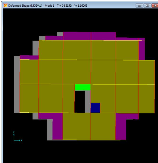
**Fig. IV.3.** 1<sup>er</sup> mode de déformation
