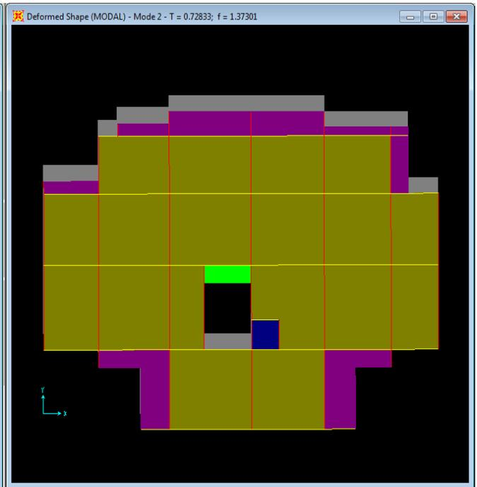
**Fig. IV.4.** 2<sup>eme</sup> mode de déformation
