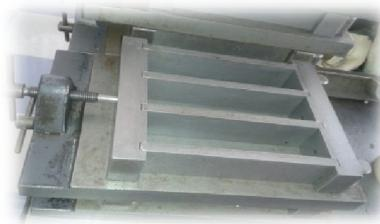
**Figure IV.2.** Le moule utilisé dans la préparation des matrices cimentaires
