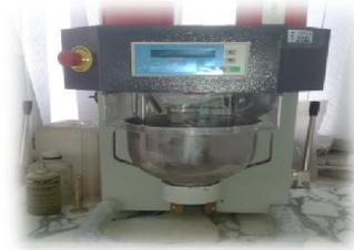
**Figure IV.1.** Le malaxeur utilisé dans la préparation des matrices cimentaires
