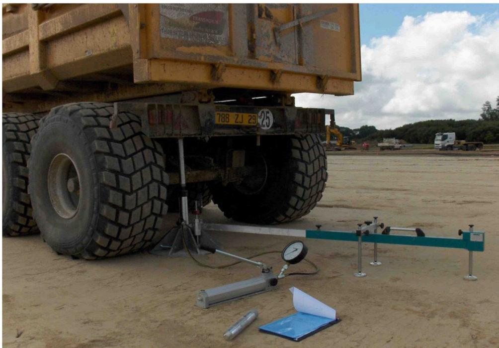
**Figure ii. 5:** principe d'exécution d'un essai a la plaque réalisé sur le site
