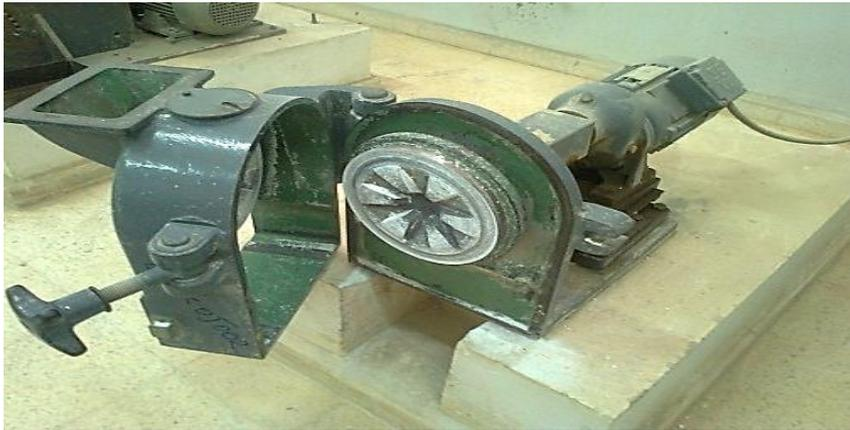
**Figure IV.3 :** Broyeur à disque (Photo prise le 24/04/2016)
