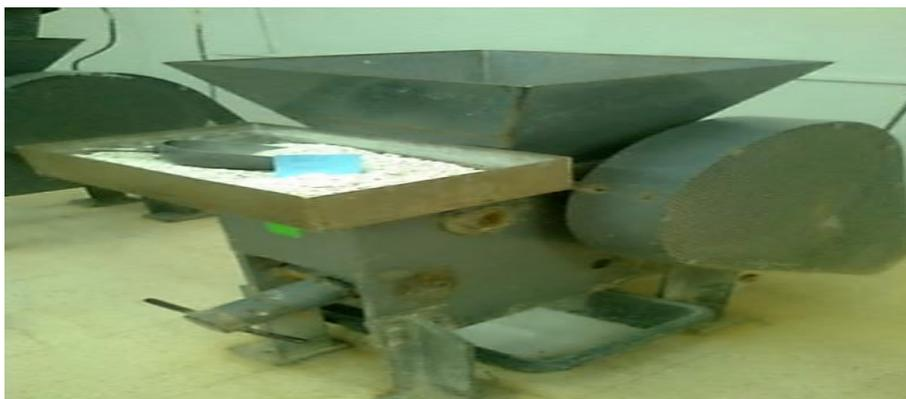
**Figure IV.1 :** Concasseur à mâchoires (Photo prise le 24/04/2016).
