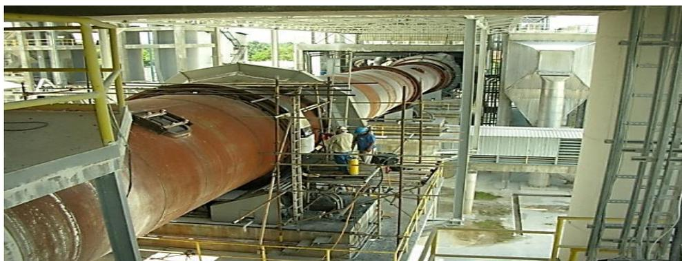
**Figure II.3 :** Four de cuisson du gypse (Photo prise le 09/03/2016).
