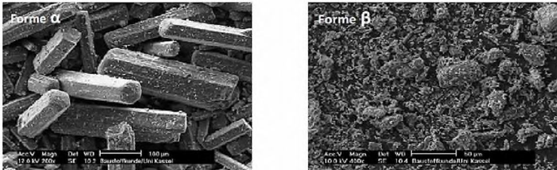
**Figure I.6 :** Photos prises au MEB des deux formes de semi-hydraté. [3]
