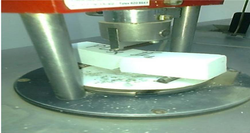
**Figure IV.13** : Machine de flexion (photo prise le 02/05/2016).
