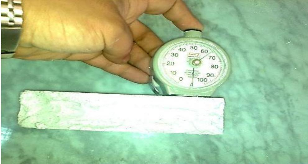
**Figure II.9 :** Duromètre SHORE-A.( photo prise le 21/05/2016)
