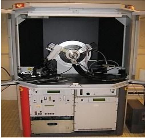
Figure II.7 : Diffractomètre X
