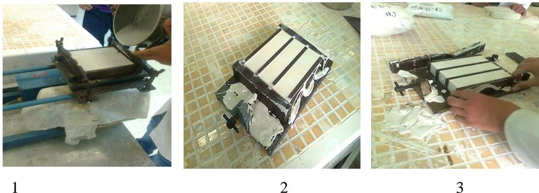
**Figure IV.12 :** Déroulement de la confection des éprouvettes de plâtre(photo prise le 26/04/2016).
