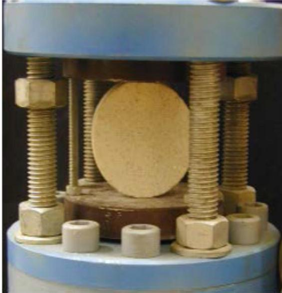
**Figure I.15.** Dispositif expérimental (Essai Brésilien).
