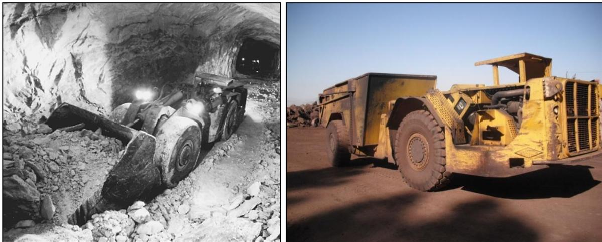
**Figure IV.9.** L'opération de chargement et de transport dans le fonds. [28]
