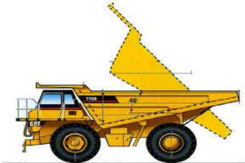
**Figure III.3.** Tombereau à châssis rigide. [7]
