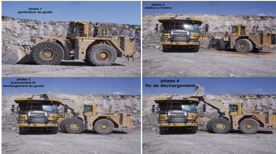
**Figure IV.1.** Chargement de roches dans la carrière.
