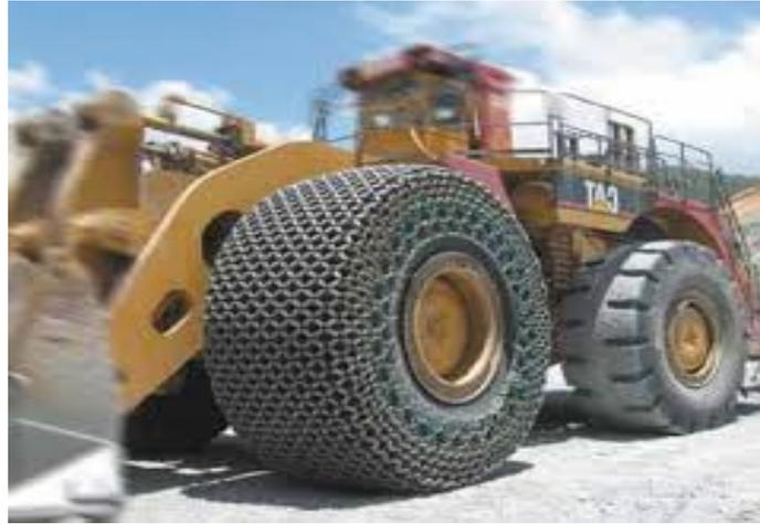
**Figure V.2.** Chargeuse équipé par une chaîne de protection.
