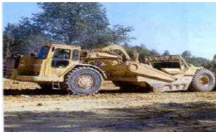
**Figure III.2.** Décapeuse ou scraper.
