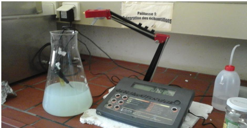
**Figure II.10:** Ajustement du pH dans le milieu 9k
