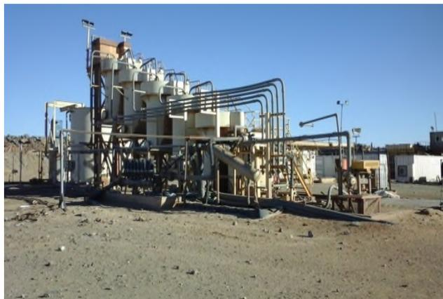
**Figure I.7:** Colonnes de charbon. [Photos prises le 17/03/2016 à Amesmassa]
