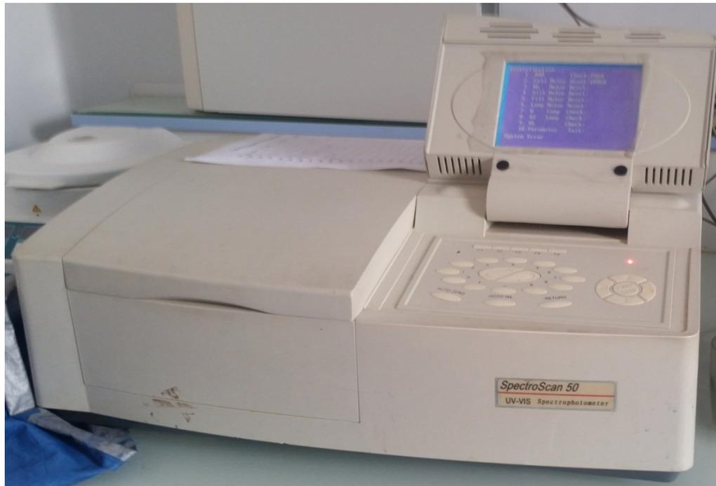
**Figure II.5:** Spectrophotomètre à Ultra-Violet Visible
