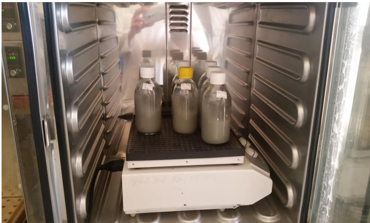
**Figure II.12:** Biolixiviation en système dynamique dans une étuve réglé à 120 rpm.
