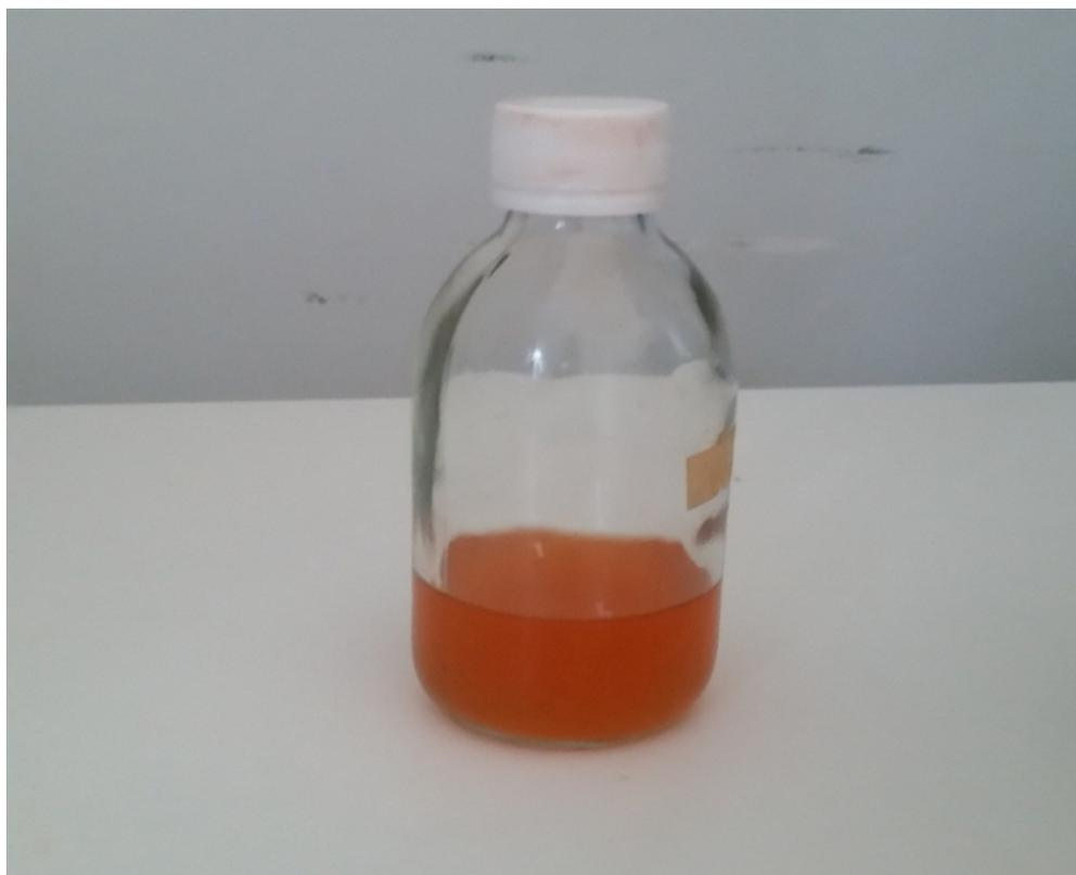
**Figure III.18:** Détermination des ions  $\text{Fe}^{2+}$  par la méthode à la phénantroline. [Photo prise le 25/05/2016 au laboratoire 3BS]
