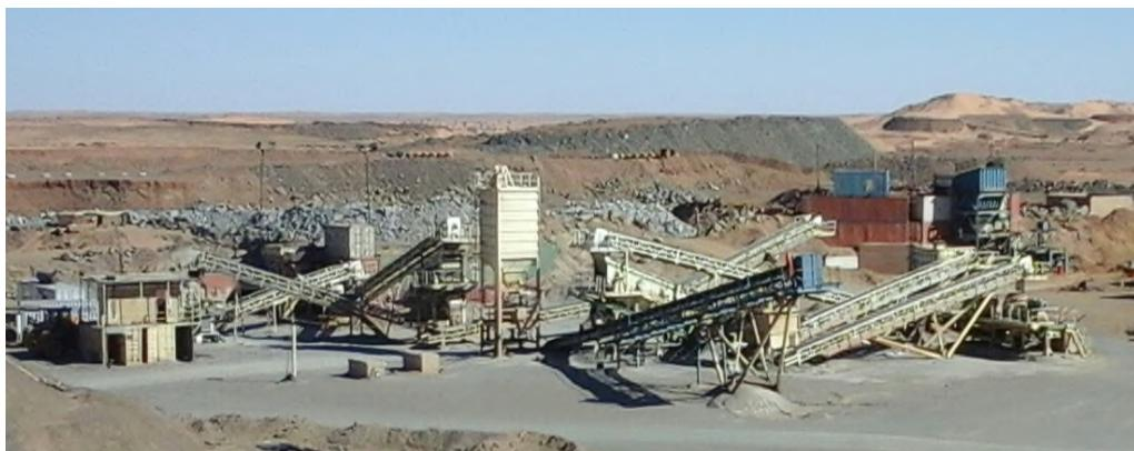
**Figure I.4:** Station de la préparation mécanique du minerai aurifère
