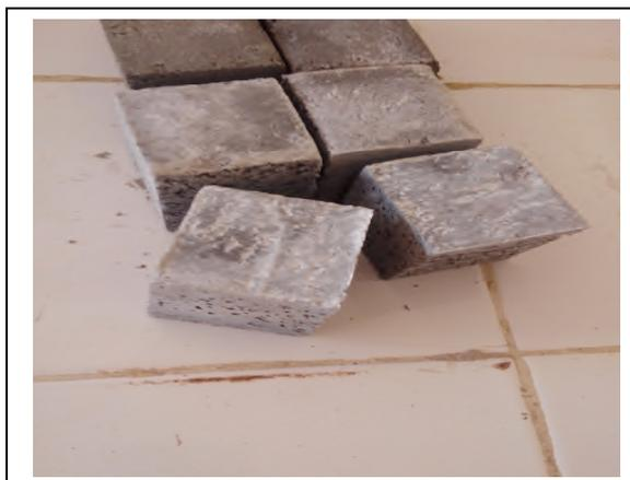
**Figure V.12.** Eprouvettes de mortier.
