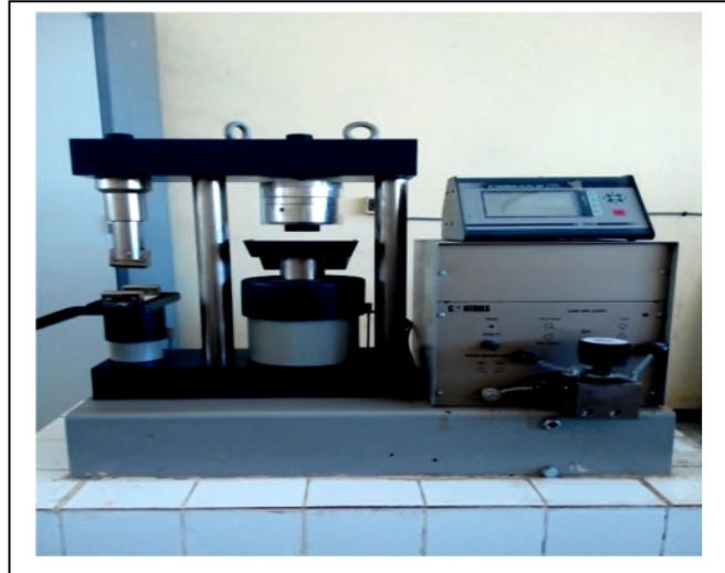
**Figure V.13.** Presse de mesure de la résistance à compression des mortiers.
