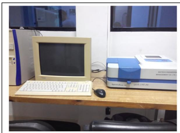
**Figure V .4.** Appareil de UV-Visible de marque Spectro scan.
