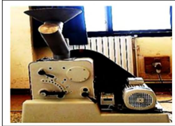
**Figure III.1** Concasseur à mâchoire de laboratoire.
