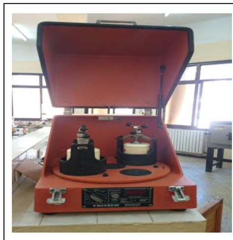
**Figure III.5** Broyeur planétaire de marque Fritsch.
