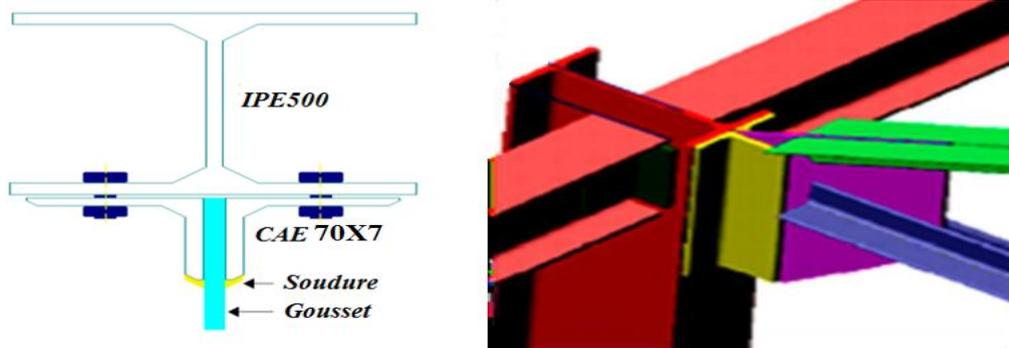
**Figure VIII.4 :** Détail assemblage ferme – poteau
