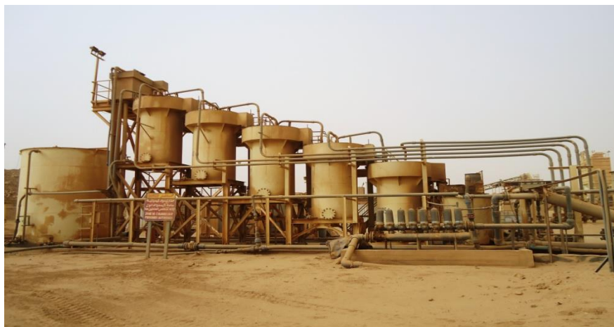
Figure II.11 : les colonnes de charbon(CIC)
