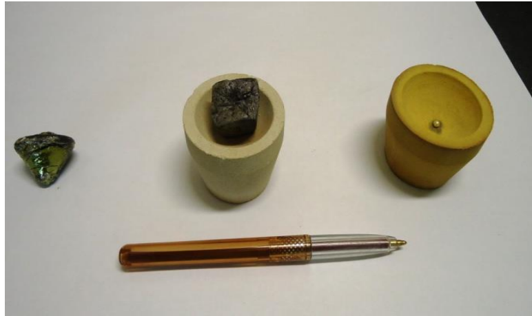
Figure III.13 : La deuxième fusion qui permet l'obtention des perles.
