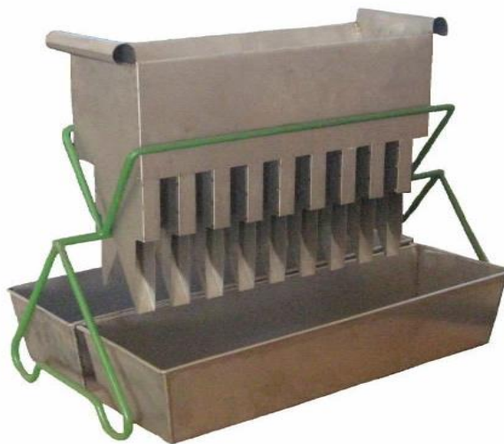
Figure III.1 : Diviseur à rifle.
