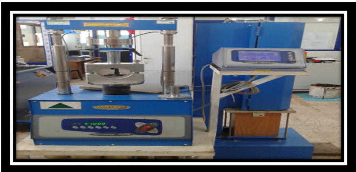
Figure II.8. Appareille MARSHALL. (LTPS Ghardaïa)
