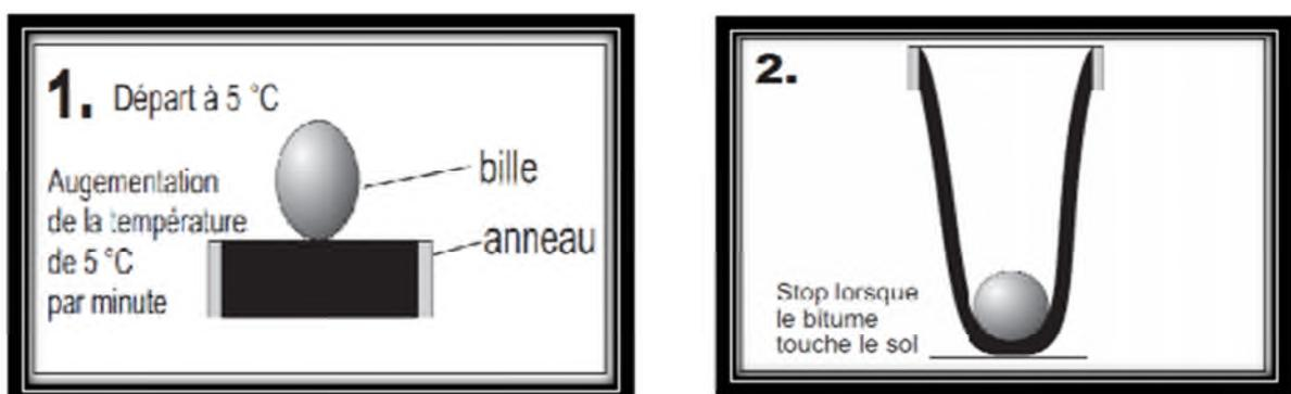
**Figure II.4.** Principe de ramollissement.
