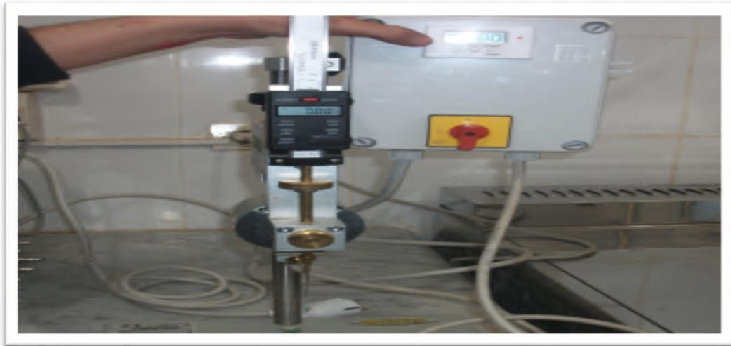
**Figure II.3.** Appareil Pénétromètre laboratoire (LTPS Ghardaïa)
