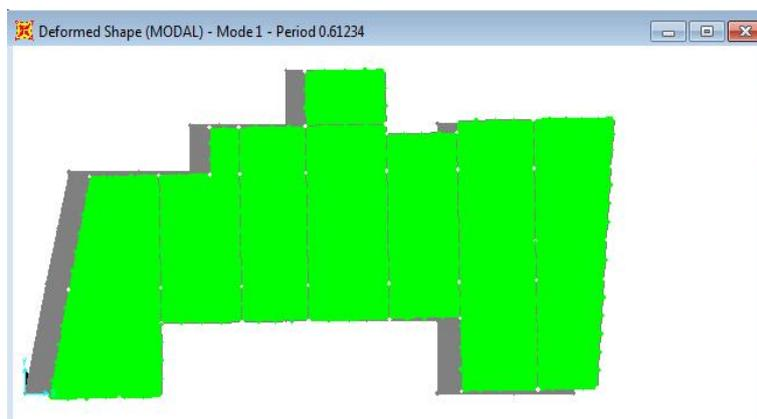
Figure. IV.2 : 1<sup>er</sup> mode de déformation
