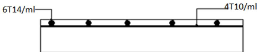
Figure.III.22 : Schéma de ferrailage de palier de repos.
