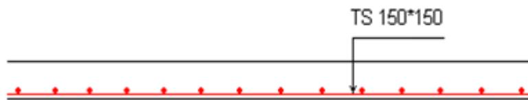
**Figure III.5.**Schéma de ferrailage de la dalle de compression
