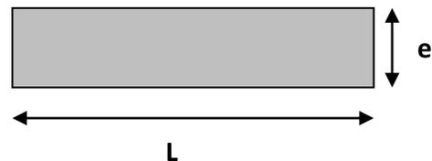
Figure II.11: Vue en plan d'un voile.
