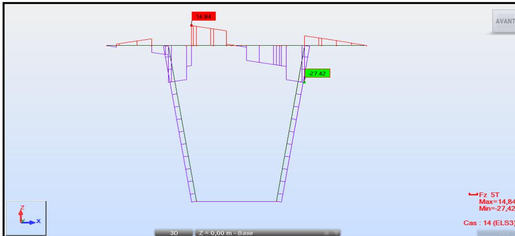
Fig. VII.7 : Diagramme des efforts tranchants sous la combinaison 3 (ELS).
