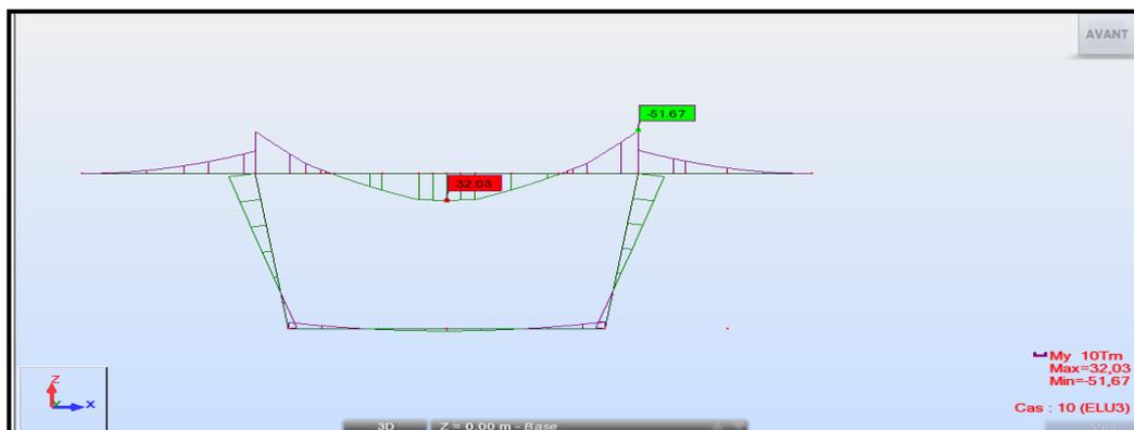
Fig. VII.9: Diagramme du moment fléchissant sous la combinaison 3 (ELU).
