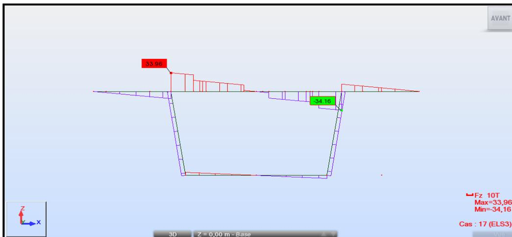
Fig. VII.13 : Diagramme des efforts tranchants sous la combinaison 3 (ELS).
