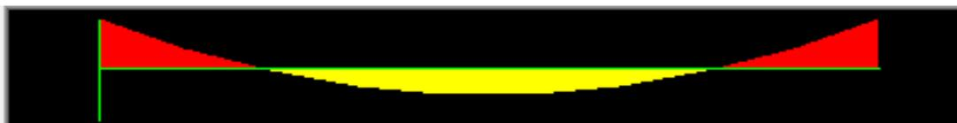
**Figure. VI.9.** diagramme des moments sens XX tirés par le SAP 2000
