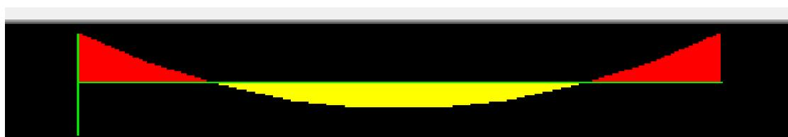
Figure. VI.8. diagramme des moments sens YY tirés par le SAP 2000
