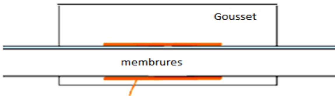
Figure VII.3 : Détail assemblage gousset-membrures de la ferme.
