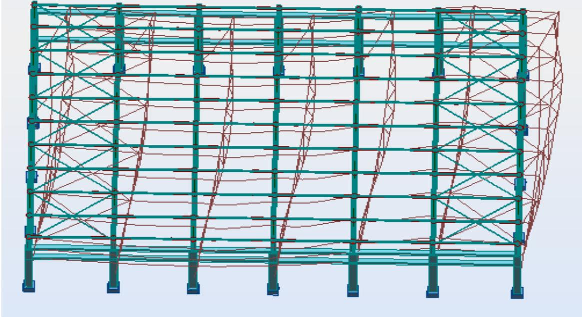
Figure V.4 : Mode de déformation (2).
