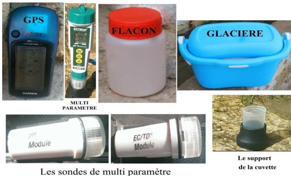
**Figure N° II.16 : Matériels utilisés sur le terrain.**
