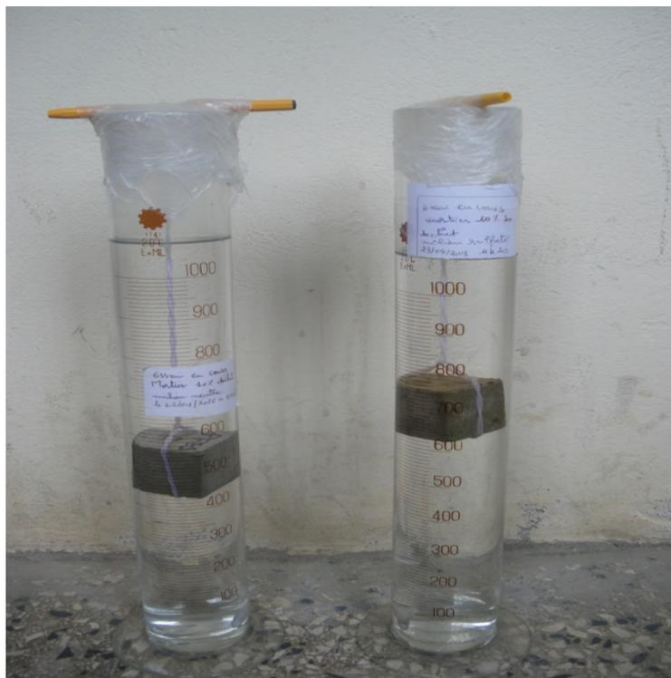
Figure 2.5. Test Lixiviation Monolithe dans deux milieux
