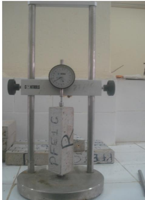
Figure 2.3. Appareil de mesure du retrait et du gonflement
