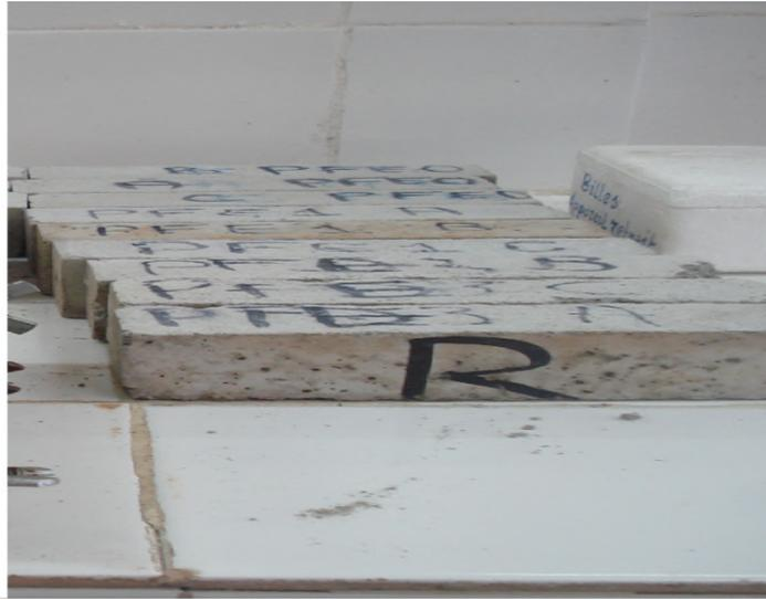
**Figure 1.19. Conservation des éprouvettes pour le retrait à l'air libre**
