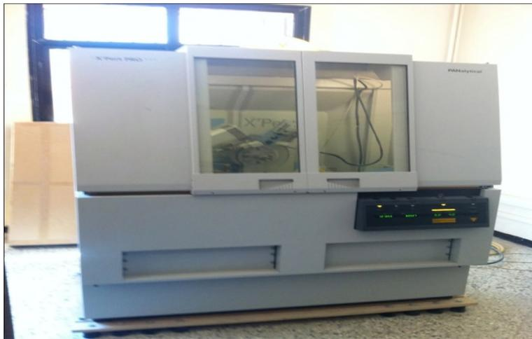
Figure 1.4. Appareil de Diffraction par des Rayons X
