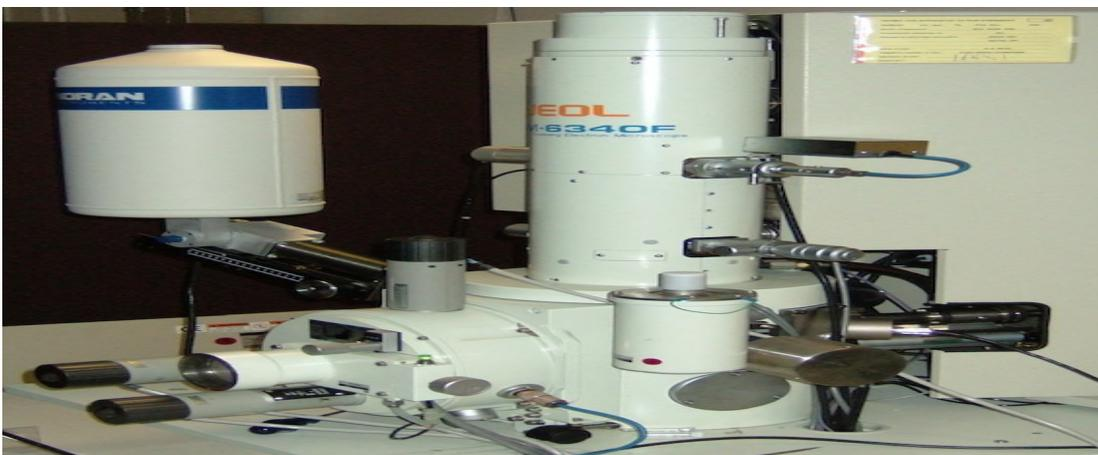
Figure 1.14. Appareil de MEB
