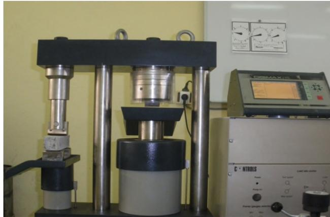
Figure 2.2. Presse hydraulique
