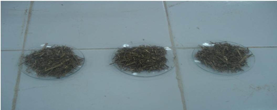
Figure 1.11. Les fibres métalliques (déchet BCR)
