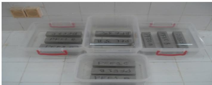
Figure 1.18. Conservation des éprouvettes du gonflement dans l'eau distillée.
